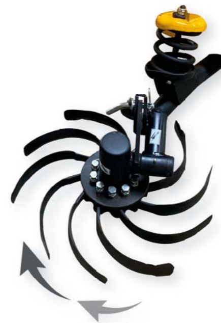
BUSA Rotor je unikátny patentovaný pracovný prvok vyvinutý na veľmi plytké a jemné spracovanie pôdy, ako aj na agresívny zásah.
