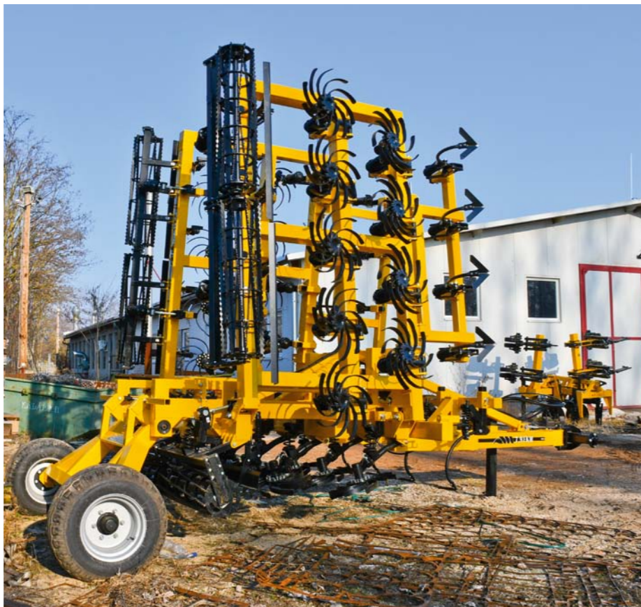
Stroje s označením FKM sú určené predovšetkým na prípravu osivového lôžka. Vyrábajú sa ako nesené aj polonesené, v pracovných šírkach od 2,7 do 10,4 m.
