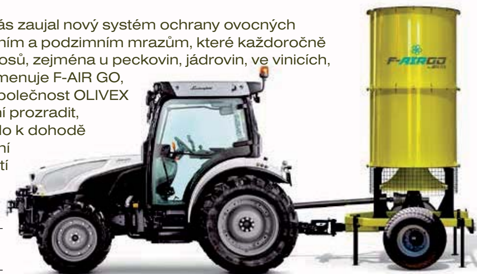
Jeden stroj tažený traktorem může pokrýt sad nebo vinici o velikosti 3,5 ha
