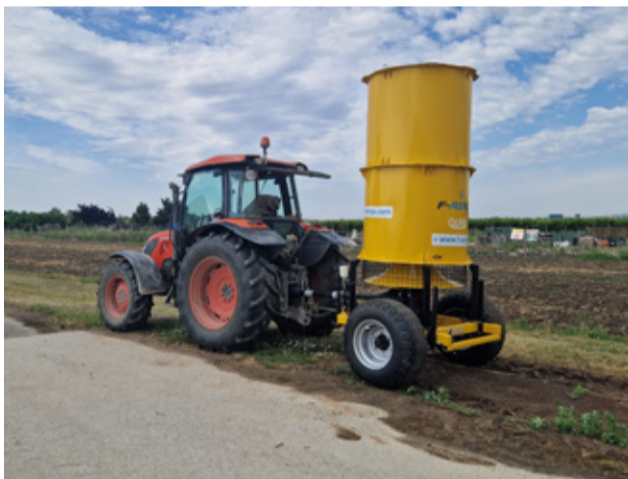
F-Airgo je stroj zabezpečujúci protimrazovú ochranu ovocných sadov, ktorý je založený na princípe premiešavania chladného vzduchu s teplejším.
