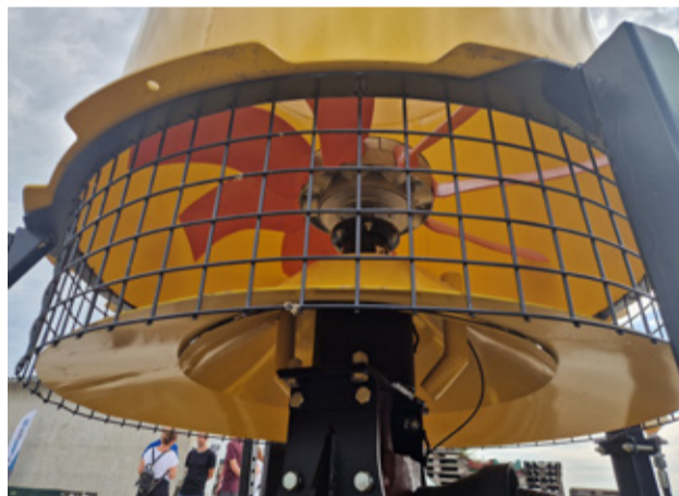
F-Airgo má pomerne jednoduchú konštrukciu, ktorá pozostáva z kovového „komína“ s ventilátorom a kuželom v spodnej časti stroja. Celok tak funguje podobne ako helikoptéra, keď tlačí vzduch z vrchných vrstiev nadol.
