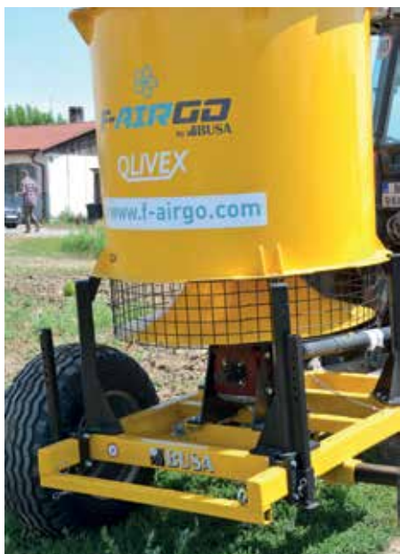
Zariadenie je založené na premiešavaní vrstiev vzduchu. Teplejší vzduch z hornej vrstvy vo výške 4 až 30 metrov sa nasáva a premieša so studeným.
